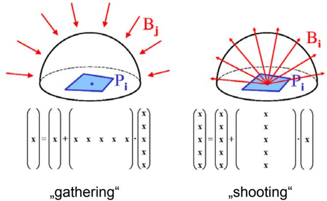
Sei  $B_{(i \text{ von } B_j)}$  der Radiosity-Anteil von  $P_i$ , der von  $B_j$  verursacht wird. Der Einfluss von  $P_i$  auf  $B_j$  ist symmetrisch zum Einfluss von  $P_j$  auf  $B_i$ :
