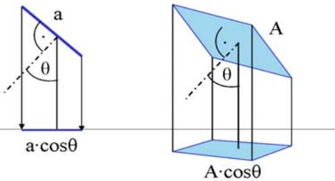
Um eine Formel für die Formfaktoren  $F_{ij}$  ableiten zu können, brauchen wir einen einfachen geometrischen Zusammenhang: Die Fläche der Normalprojektion einer Fläche  $A$  auf eine andere Fläche verkleinert sich um den Cosinus des Winkels zwischen den Flächen, ist also  $A \cdot \cos\theta$ .
